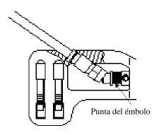
Insertar cable y conector Figura 1
