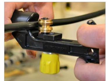
El diseño del mango "T" mejora el apalancamiento y la ergonomía durante cortes longitudinales o de anillo.
